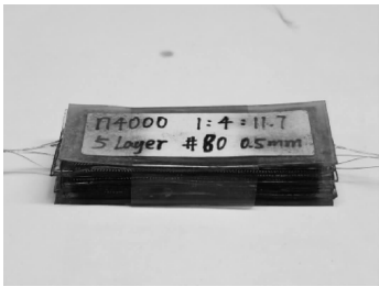
图3 组装的5层PVC-gel叠层驱动单元
